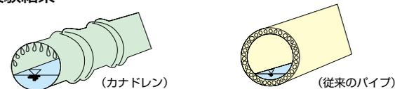
圧力水頭の大きい下部からの吸水が多いが、側面、上部の順に、管全周から吸水されている。
