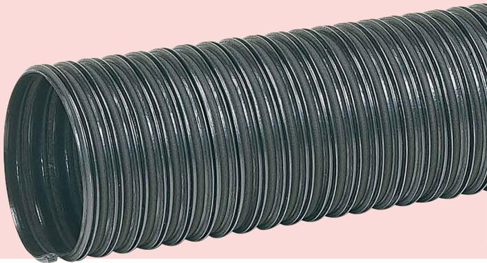
フィルター効果に優れた高強度ポリプロピレン不織布と、高剛性ポリプロピレン補強体を用いた土木用透水パイプです。管壁自体が不織布という透水体で作られているので、一般の有孔管よりも透水面積が大きく、理想的な吸水効果が得られます。
